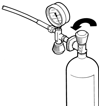
Abb. 9 Anschließen der Druckluftflaschen
